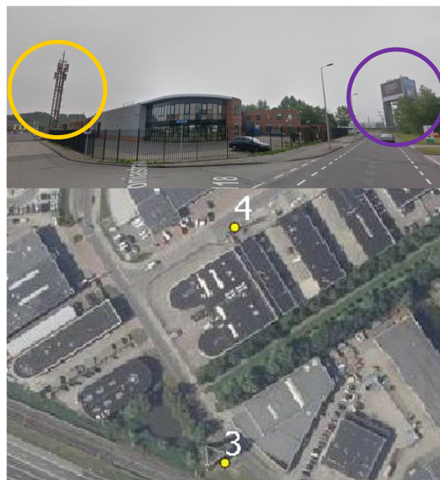
Figuur 35 Clustering van antenne-installaties binnen een straal van 40 meter op twee dichtbij zijnde locaties (bron: Google Maps, Antenneregister en analyse Dialogic)
